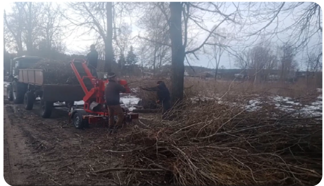
Рисунок 11. Використання подрібнювача гілок TN 130 DKL при розчищенні чагарників
